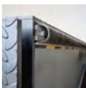
JUNTA DE ESTANQUEIDAD DE RAMPA
